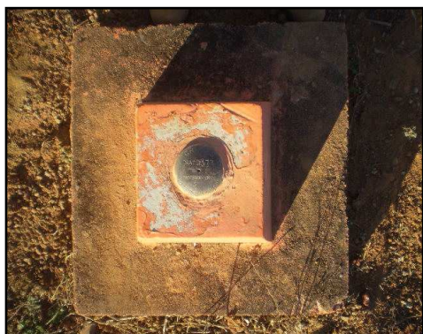
Figura 2 – Detalhe do marco geodésico SAT 93726.
