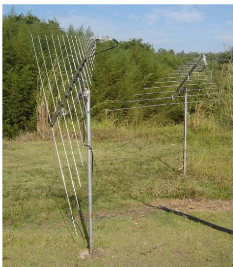
Figura 2– Antenas dos espectrógrafos CALLISTO-BR instaladas em janeiro de 2010 e em operação regular em Cachoeira Paulista.
