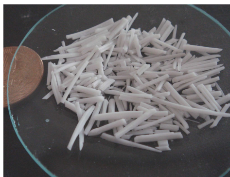
Figura 5. Extrudado obtido com o agente peptizante ácido nítrico 10%.
