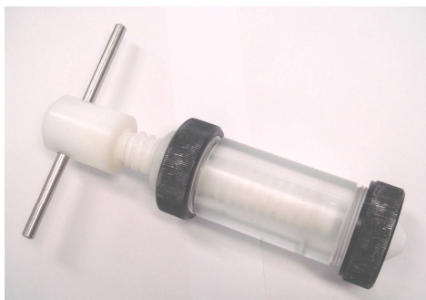
Figura 2. Dispositivo de moldagem utilizado para a produção dos “pellets”.
