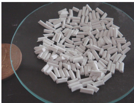
Figura 6. Extrudados típicos obtidos com os demais agentes peptizantes. Características ideais para atuar como suporte catalítico.
