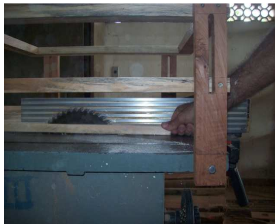
Figura 5 – Serra circular com dispositivo de segurança instalado
