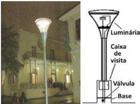
Figura 9- Sistema de iluminação a gás. Fonte: CENBIO, 2007b.
