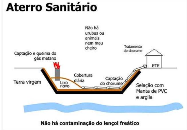
Figura 8- Exemplo da disposição de um aterro sanitário.
