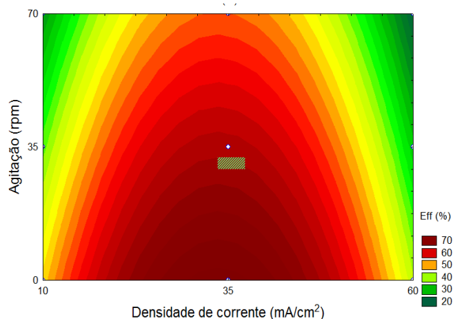
Figura 3 - Superfície de contorno da liga Ni-Mo-P para a eficiência catódica em função da agitação mecânica e densidade de corrente
