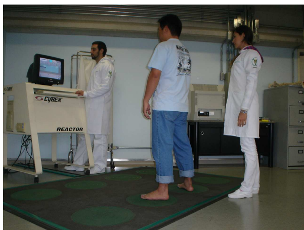
Figura 1- Indivíduo realizando o protocolo Parkinson's PP1 ( Stability anterior/ posterior ) no equipamento Cybex Reactor®.
