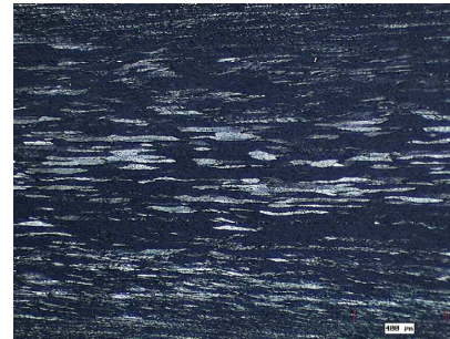
Figura 2 – Micrografia mostrando a estrutura do Alumínio liga AA1100, após laminação a quente (1 passe) antes do processo de tratamento térmico, aumento de 50X.
