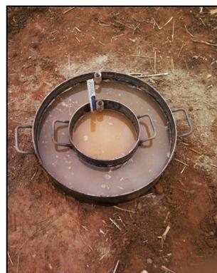
Figura 2 - Detalhamento do método infiltrômetro de anel.
