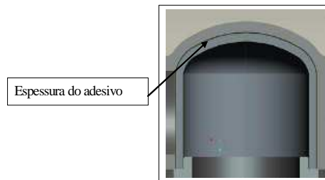
Figura 05 – Espessura do adesivo
