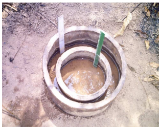
Figura 1: Infiltrômetro de anéis concêntricos.
