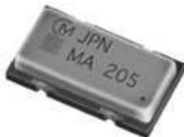
Figura 2 – Fotografia do giroscópio utilizado como sensor de movimento do dispositivo inercial para aplicação em robótica.
