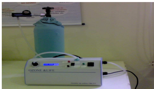
Figura 1- Gerador de Ozônio que produz 3g/h de ozônio por 2l/min de oxigênio puro – Acervo pessoal.
