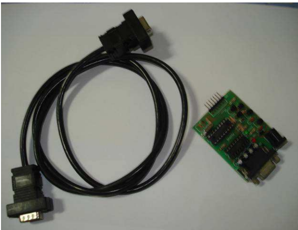
Figura 04-Cabo de comunicação DB09 e Placa com microcontrolador PIC 16f84a.
