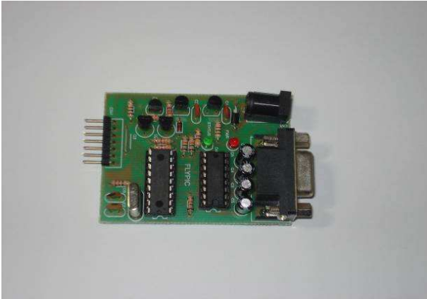
Figura 03-Placa com microcontrolador PIC 16f84a.
