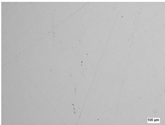
Figura 4- Fissuras na caixa branca de PU.
