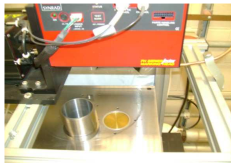
Figura 4 - Dispositivo de sinterização, em destaque, a superfície do pistão onde forma-se a cavidade de armazenagem do pó.
