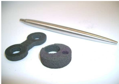
Figura 6 - Partes produzidas em aço 1020 pelo dispositivo de sinterização. A altura da parte esta relacionada com a quantidade de camadas a serem sinterizadas, e a espessura da camada é limitada ao tamanho médio das partículas do material de partida.
