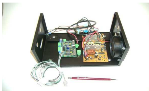
Figura 3- Circuito Eletrônico com suporte para dois motores de passo.
