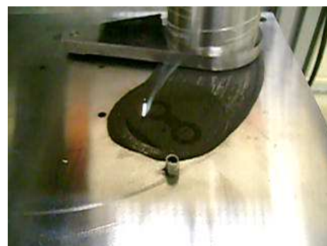
Figura 5 - A cavidade é preenchida com pó e irradiada pelo feixe de laser de CO 2 . A região clara na Figura é a região irradiada pelo feixe. A parte escura é a região sinterizada.
