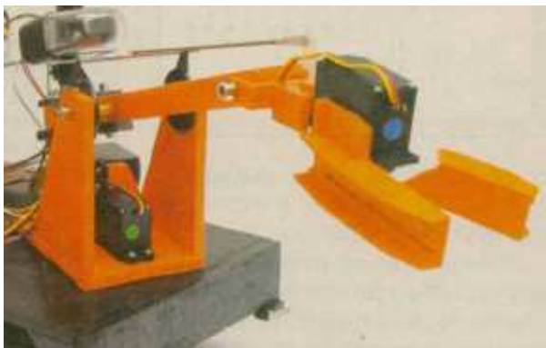
Figura 1: Braço Articulado com o Posicionamento dos Servo-Motores.
