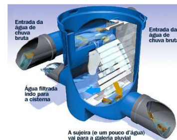
Figura 2: Esquema do Filtro VF1 utilizado no projeto.
