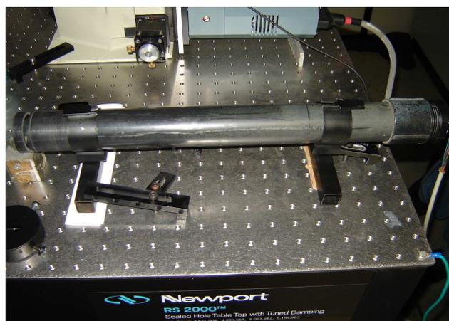
Figura 4- Canhão de LED utilizado para emissão de luz no CCD.
