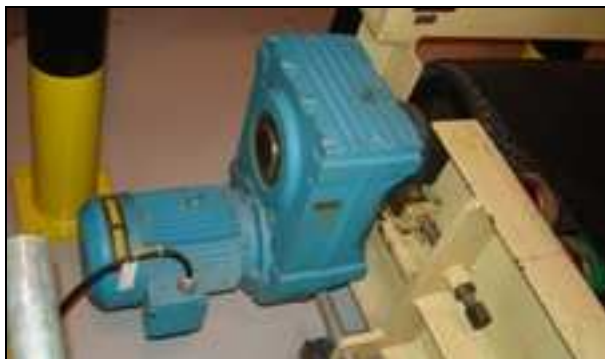
Figura 6: Detalhe do motor elétrico e redutor adaptados para movimentar a nova esteira transportadora.
