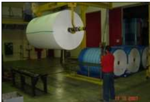
Figura 1: Fotografia mostra funcionário manuseando bobinas com ajuda de ponte rolante.
