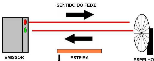
Figura 7: Imagem mostra esquema de funcionamento da foto-célula retro reflexiva usada no sistema, onde a esteira se posiciona entre o emissor e o espelho.
