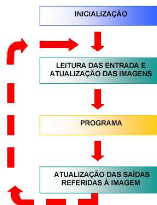
Figura 9: Imagem mostrando o fluxograma de funcionamento básico de um PLC similar ao que foi utilizado no projeto.
