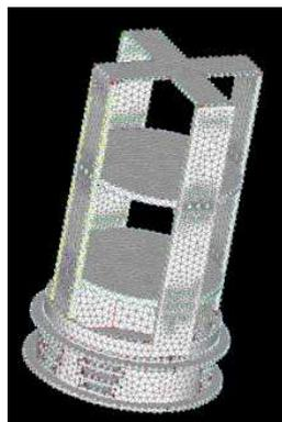
Figura 4: Malha gerada na estrutura interna do MEXP.
