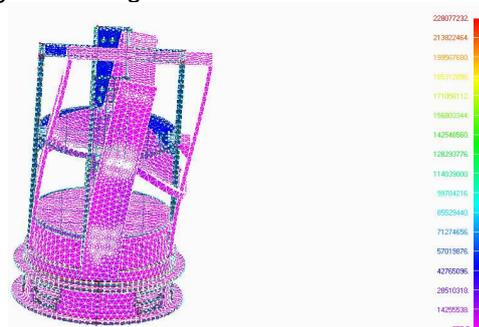
Figura 5 - Carregamento Longitudinal estático de compressão no MEXP.
