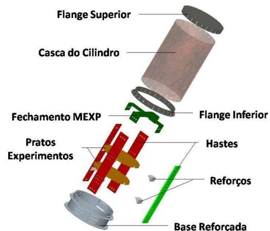
Figura 3 – Vista Explodida do modelo do Cilindro MEXP gerado no Pro-E.
