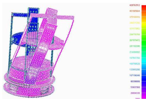
Figura 7 - Carregamento Transversal estático no MEXP.
