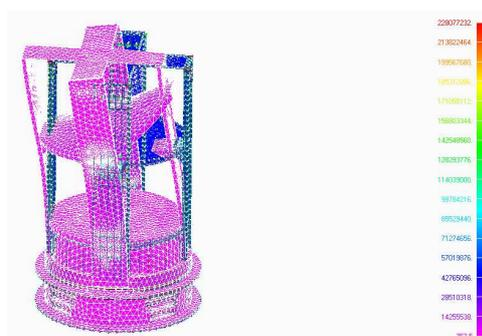
Figura 5 - Carregamento Longitudinal estático de Tração no MEXP.
