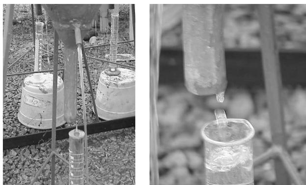
Figura 1- Visão geral do ensaio da condutividade hidráulica no vaso saturado.
