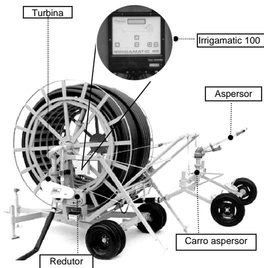
**Figura 1.** Conjunto autopropelido HIDRO ROLL 90/240
