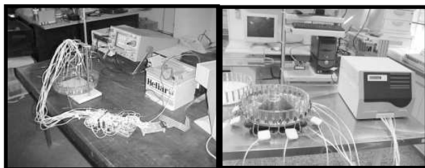
Figura 2 – Aparelho produzido na FMUSP - do protótipo inicial do aparelho de tomografia por bioimpedância elétrica à versão mais recente. Fonte: ALMEIDA (2005)
