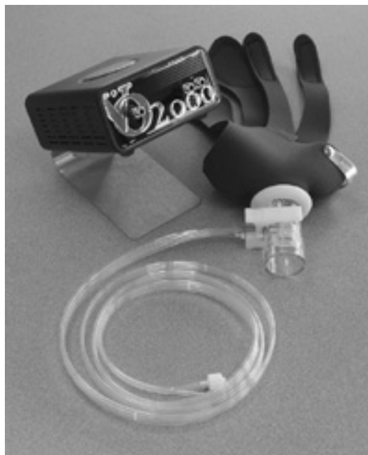
Figura 1 – Pneumotacógrafo Externo e analisador de gás metabólico (VO2000).
