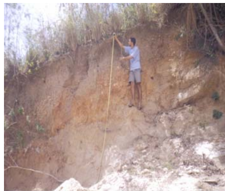
Figura 1- Perfil de solo do tipo corte de estrada descrito no sitio Camucá do Angelim, indicando a modificação dos horizontes superficiais.
