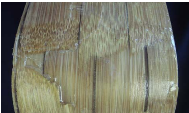
Figura 7. Ruptura causada por descontinuidade das fibras durante o processo de fabricação.
