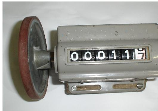
Figura 5 – Hodômetro Mecânico.
