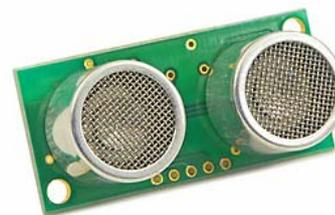
Figura 5: Fotografia do modelo de sonar utilizado no dirigível
