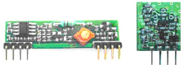
Figura 4: Fotografia do módulo transmissor/receptor RF
