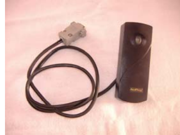
Fig. 4- Sensor magnético um dos periféricos que podem ser usados para fornecer dados ao sistema.
