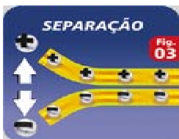
Figura 3- Indução de eletricidade estática por separação brusca dos materiais ou carga triboelétrica.
