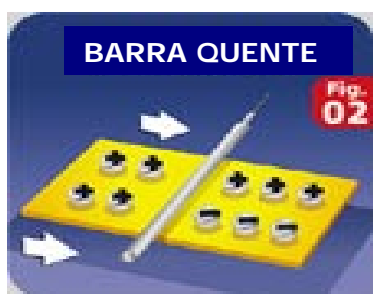
Figura 2- Indução de eletricidade estática por calor.
