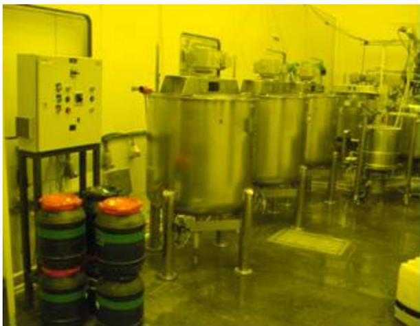
Figura 5. Tanques de suspensão e preparação da solução de fósforo a ser aplicado na tela de cinescópios.
