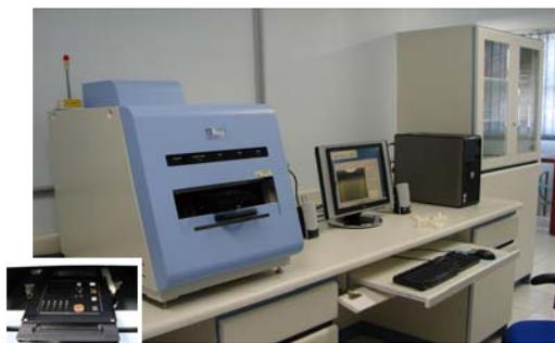
Figura 3: Fotografia do espectrofotômetro de Fluorescência de Raios-X por energia dispersiva, marca Shimadzu modelo  $\mu$ EDX-1300. Detalhe: compartimento do porta-amostras.
