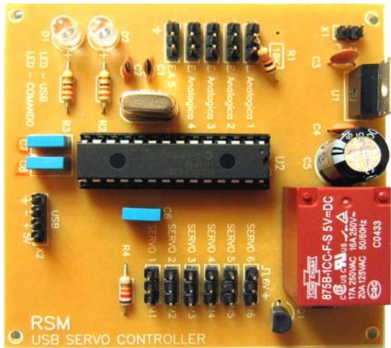
Figura 4- Placa de controle de servomotores (08 – unidades) via USB.
