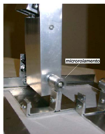
Figura 3: Fotografia do micro-rolamento na articulação do tornozelo do robô bípede
