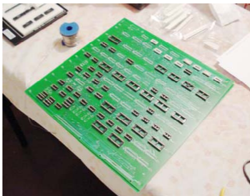
Figura 6 - Foto da placa de controle sendo montada com os soquetes.
