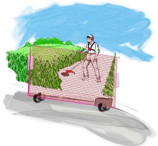
Figura 2: Com a automatização da tela de proteção, deixa de ser necessário o operador ao nível das vias de automóveis, aumentando a sua segurança.
