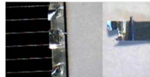
Figura 5: Aparência típica da ruptura as solda do interconector de kovar com 0,050 mm de espessura após o teste destrutivo de resistência mecânica.
