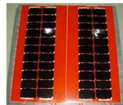
Figura 10: Cupom de teste Modelo de Qualificação da PMM.
