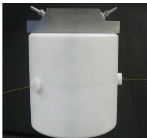
Figura 4: Esfera Integradora com a fibra óptica e a peça de inox.
