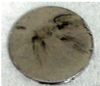
Figura 5 – Amostra 2B. Pastilha de estanho prensada, mostrando o efeito (manchas escuras) da não remoção dos aditivos presentes na liga metálica. Espessura: 300 µm. Diâmetro: 13 mm
