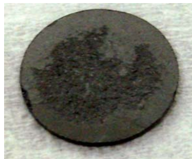
Figura 3 - Amostra 4A. Pastilha de grafite prensada com 10ton por 10min, sem vácuo. Espessura: 400 µm.
