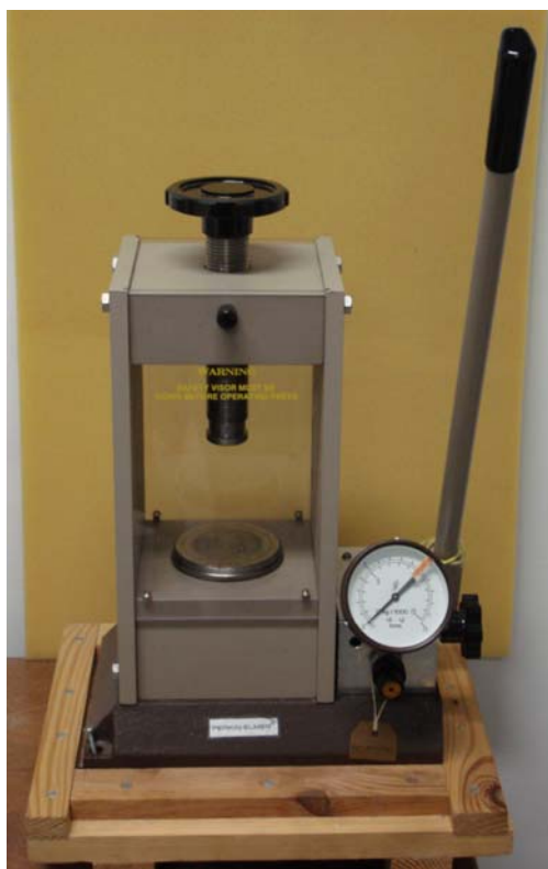
Figura 1: Prensa utilizada na prensagem a frio dos materiais para fabricação das pastilhas. Capacidade: 15 toneladas.
