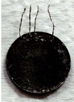
Figura 6 – Pastilha híbrida com termopares soldados. Vista do lado metálico.
