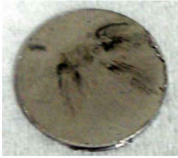
Figura 5 – Amostra 2B. Pastilha da liga estanho-chumbo
