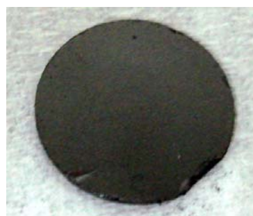
Figura 4 - Amostra 7A Pastilha de grafite prensada com 15 ton por 10min, com vácuo. Espessura: 500 µm.
