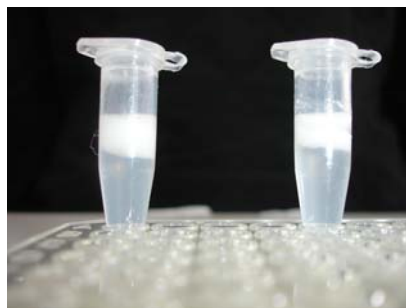
Fig. 2: Teste de centrifugação sem separação de fases no creme e gel creme base (controles)
