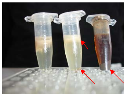
Fig. 4: Teste de centrifugação sem separação de fases no creme contendo extrato etanólico e com separação de fases no extrato etanólico e no gel creme contendo extrato etanólico.
