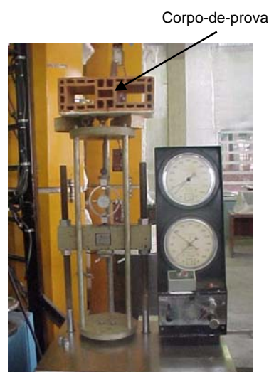
Figura 1 – Máquina Universal adaptada ao ensaio de arrancamento.
