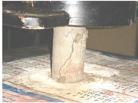
Figura 2 – Detalhe da fissura de um corpo de prova.
