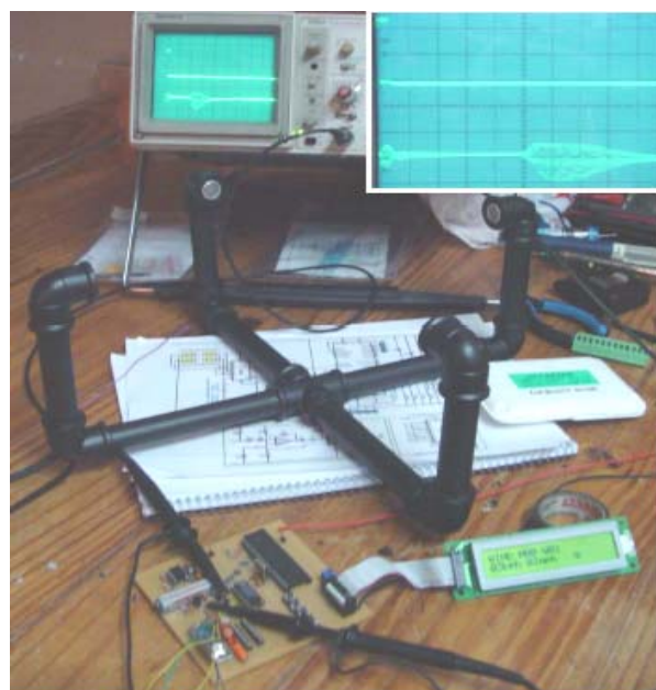
Figura 4- Protótipo experimental do anemômetro em teste
