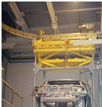
Figura 1: Transportador aéreo tipo EOM de cabinas.
