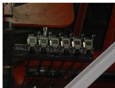
Figura 6 – Limites de indicação de posicionamento e comutação de velocidade do transportador aéreo de cabinas
