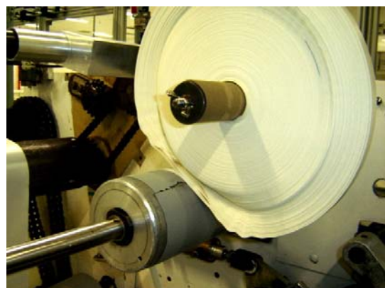
Ourela sem o oscilador. Atingido determinado diâmetro, pode ocorrer esse tipo de problema, causando parada de máquina para sua troca.
