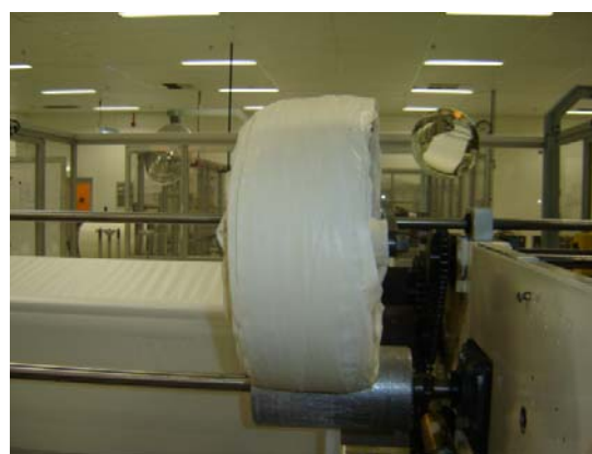
Ourela com o oscilador. Mais larga, aproveitando melhor o tubete e dando mais estabilidade no enrolamento.
