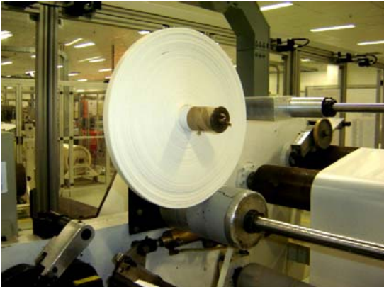
Enrolamento fixo aumentando rapidamente o diâmetro do rolo.
