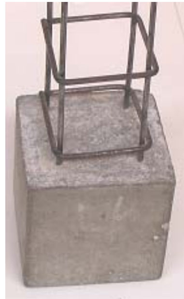
Figura 3- Modelo de pilar parcialmente concretado, após a cura e retirada das fôrmas [executado pelos alunos].
