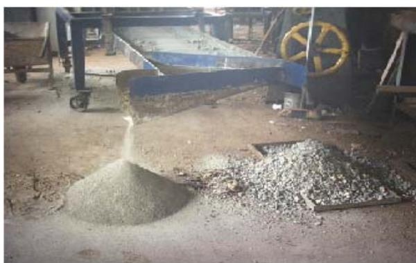
Figura 5: Resultado do processo de reciclagem: à esquerda o agregado pronto para ser utilizado; à direita, para ser reprocessado.
