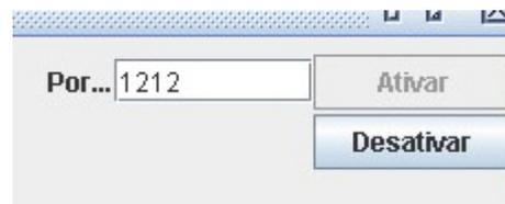
**Fig.2** – Botões para ativar e desativar o sistema. O campo editável permite definir a porta TCP de operação do sistema.
